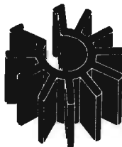
Fig. 8 - Il transistor TR3 emana una notevole quantità di calore durante il funzionamento del trasmettitore, soprattutto se questo lavora ai limiti massimi di potenza consentita. Occorre quindi munirlo di adatto radiatore, di cui quello qui riprodotto rappresenta un valido esempio.
